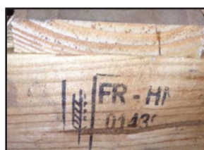
Marcas inaceptables (Ilegible)
